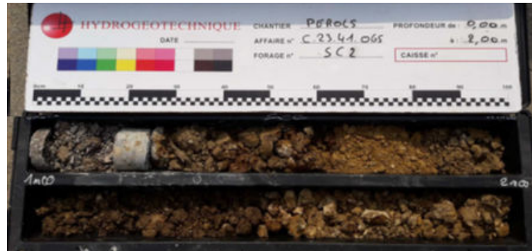
Exemple de résultat : un forage de reconnaissance géologique à 2m de profondeur
